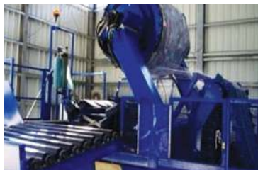
Mise en balles : système pour enrubanner les déchets compactés et ainsi mieux gérer le stockage
