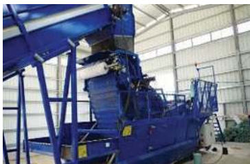
Mise en balles : système pour enrubanner les déchets compactés et ainsi mieux gérer le stockage
