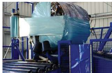
Mise en balles : système pour enrubanner les déchets compactés et ainsi mieux gérer le stockage
