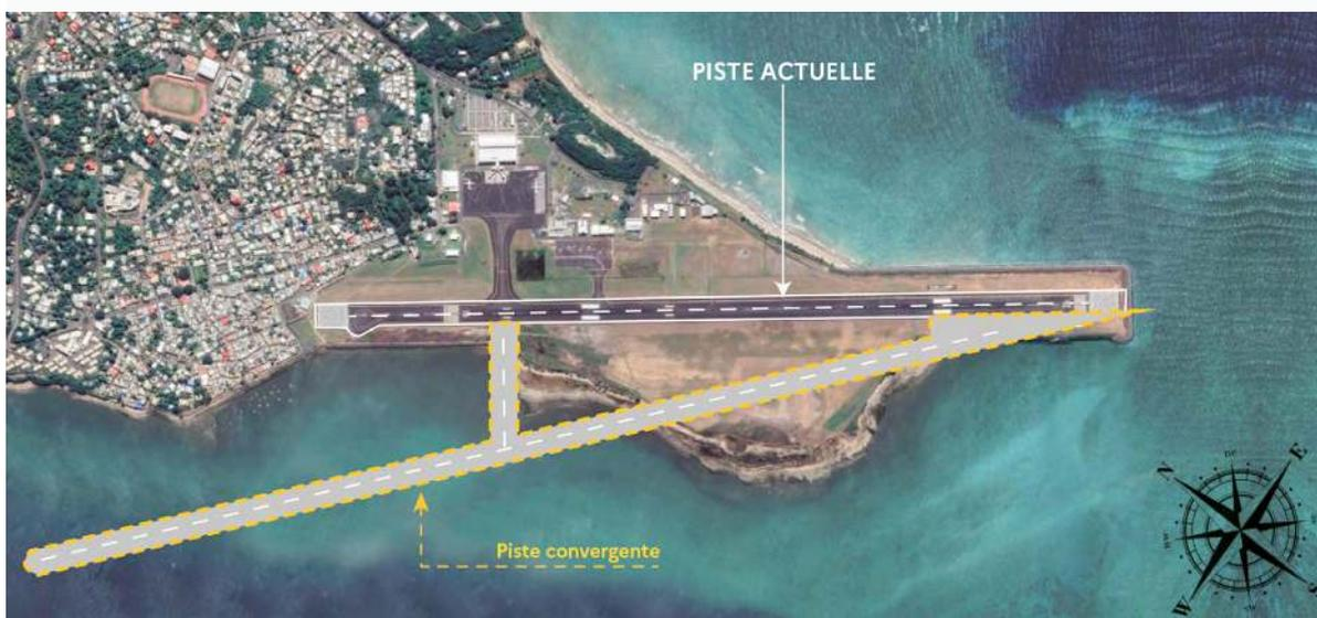
Pour répondre aux besoins, la piste actuelle de 1930 mètres sera allongée à 2510 mètres. La piste convergente nécessite la construction d'un remblai-digue de sept à huit mètres de haut, qui recouvrira les habitats marins de la zone. Cette nouvelle piste permettra toutefois de réduire les nuisances sonores et émissions de poussières pour les habitants de Pamandzi.
