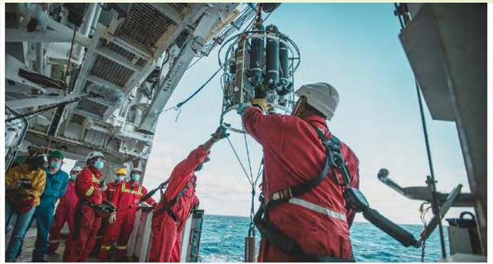
Mise à l'eau de la rosette de prélèvement d'échantillons d'eau.
